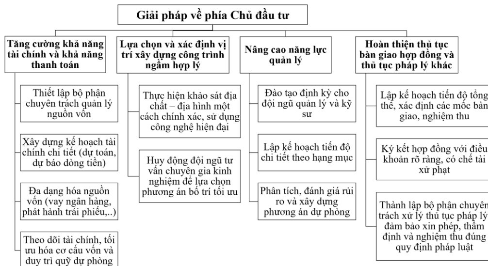
Hình 5. Giải pháp về phía chủ đầu tư trong quản lý rủi ro chi phí xây dựng công trình ngầm.
