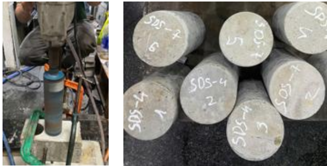
(a) Mẫu được khoan từ mẫu đầm (b) Các mẫu sau khi khoan
