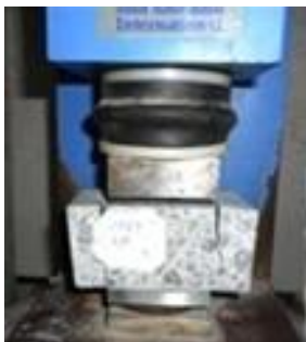
Hình 4. Thí nghiệm xác định cường độ chịu nén của mẫu vữa.
