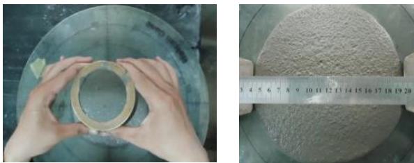
(a) Thao tác nhấc khâu hình côn (b) Thao tác đo đường kính Hình 3. Quy trình thí nghiệm độ lưu động của vữa tươi.
