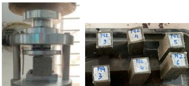
(c) Thí nghiệm nén mẫu vữa (d) Thí nghiệm hệ số hút nước do mao dẫn của mẫu vữa
