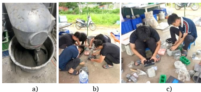
Hình 3. Trộn và đúc mẫu bê tông.
