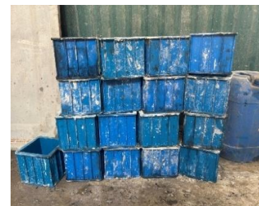
b) Khuôn mẫu bê tông
