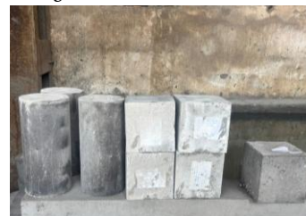
c) Mẫu bê tông thí nghiệm
