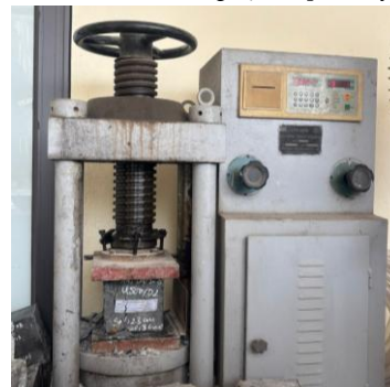
c) Nén mẫu bê tông thí nghiệm
