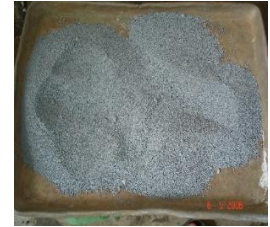
b. Silica fume SF-90 của công ty Elkem
