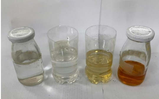
Hình 4. Phụ gia siêu dẻo vào nước sạch nhào trộn.
