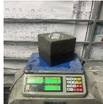
a) Xác định khối lượng thể tích của mẫu bê tông thí nghiệm
