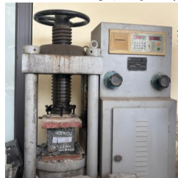
c) Nén mẫu bê tông thí nghiệm
