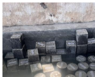
a) Bảo dưỡng mẫu bê tông thí nghiệm
