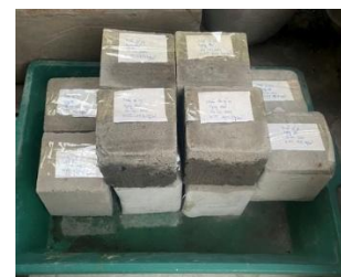
b) Các mẫu bê tông thí nghiệm
