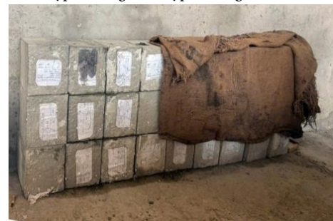
c) Bảo dưỡng các mẫu bê tông thí nghiệm
