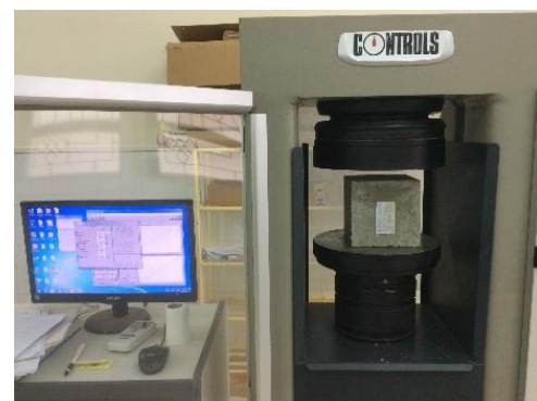
c) Nén mẫu bê tông thí nghiệm
