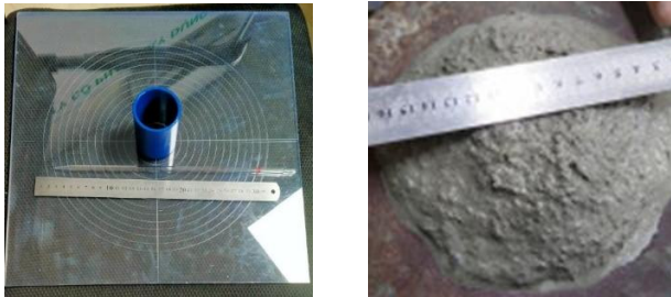
(a) Bộ dụng cụ nhốt kế Suttard (b) Đo độ chảy xòe của hỗn hợp vữa Hình 2. Thí nghiệm xác định độ chảy của hỗn hợp vữa.
