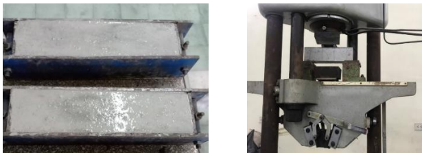
(a) Chuẩn bị mẫu theo kích thước chuẩn (b) Thí nghiệm uốn mẫu Hình 3. Chuẩn bị mẫu và thí nghiệm uốn mẫu vữa đóng rắn.
