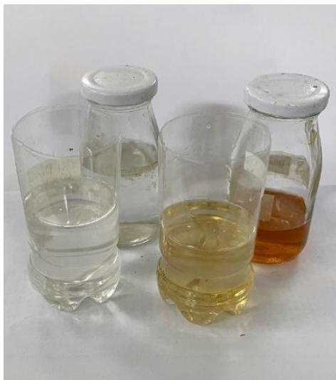
Hình 3. Phụ gia siêu dẻo hoạt hoá.
