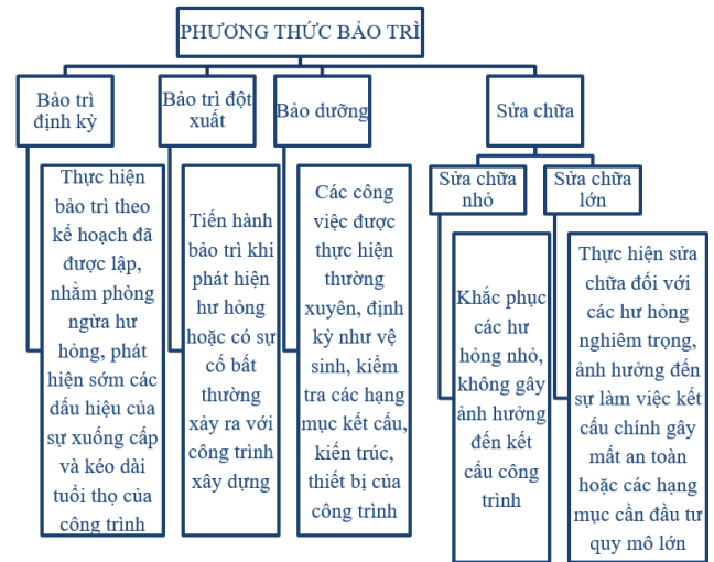
Hình 2. Các loại hình bảo trì dưới các hình thức khác nhau.
