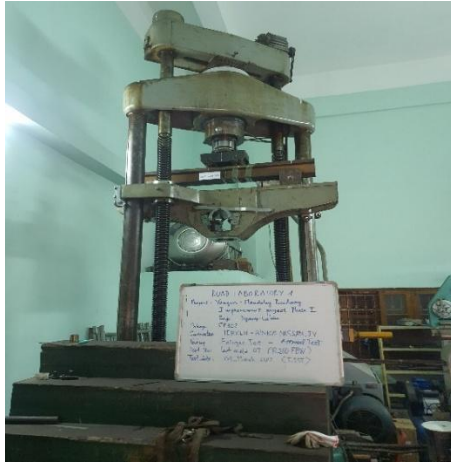
Hình 5. Thí nghiệm môi trên hệ thống thiết bị kéo nén vạn năng 100T- VPM-2A (Nga) ngày 01/3/2022.
