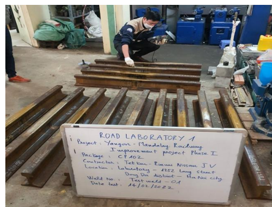
Hình 1. Siêu âm mối hàn ATW dự án đường sắt Yangon Mandalay - Myanmar ngày 14/02/2022.
