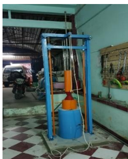
Hình 8. Thí nghiệm đánh giá chất lượng đá Ballast dự án Metro line 1 ngày 11/7/2018.
