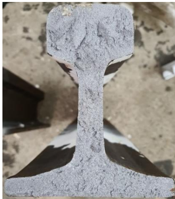
Hình 7. Đánh giá mặt gãy mẫu phá hủy sau khi uốn ngày 17/3/2022.
