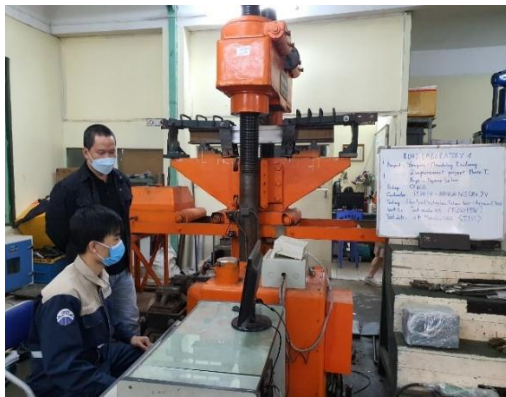
Hình 6. Thí nghiệm uốn sau khi thí nghiệm môi ngày 17/3/2022.
