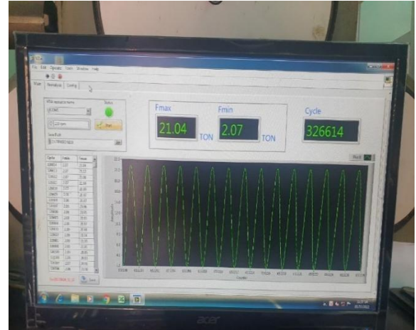
Hình 5. Thí nghiệm môi trên hệ thống thiết bị kéo nén vạn năng 100T- VPM-2A (Nga) ngày 01/3/2022.
