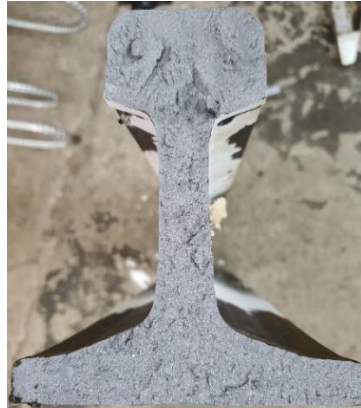
Hình 7. Đánh giá mặt gãy mẫu phá hủy sau khi uốn ngày 17/3/2022.
