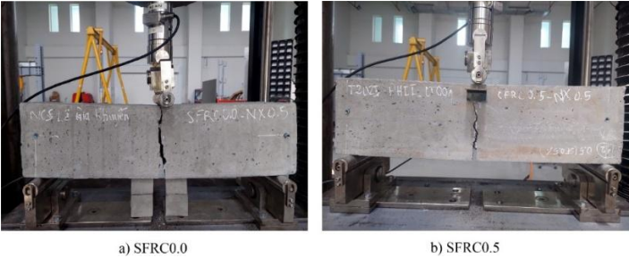
Hình 9. Hình ảnh dầm bị phá hoại trong hai trường hợp: (a) Không có sợi thép; (b) Hàm lượng 0,5 % sợi thép.
