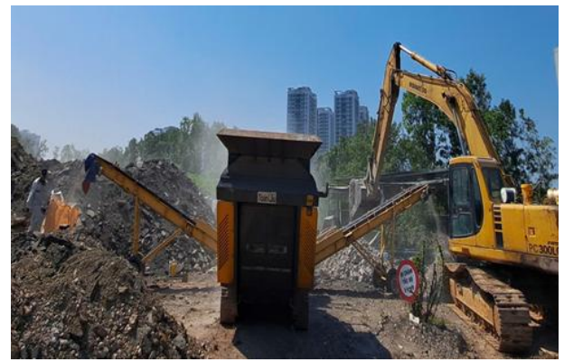
b. Cốt liệu được sàng phân thành các loại đường kính cỡ hạt
