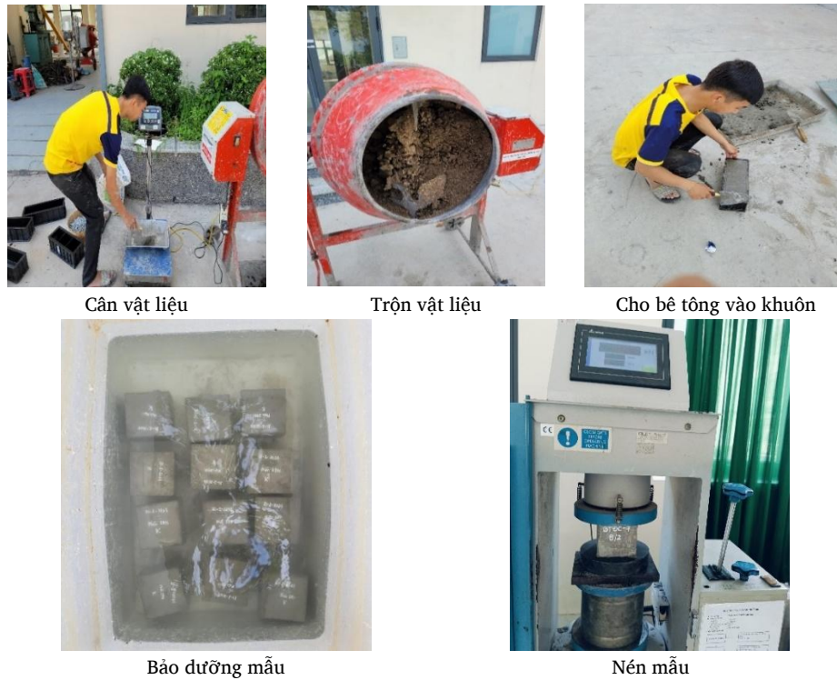
Hình 6. Trình tự thực hiện việc đổ và nén mẫu.
