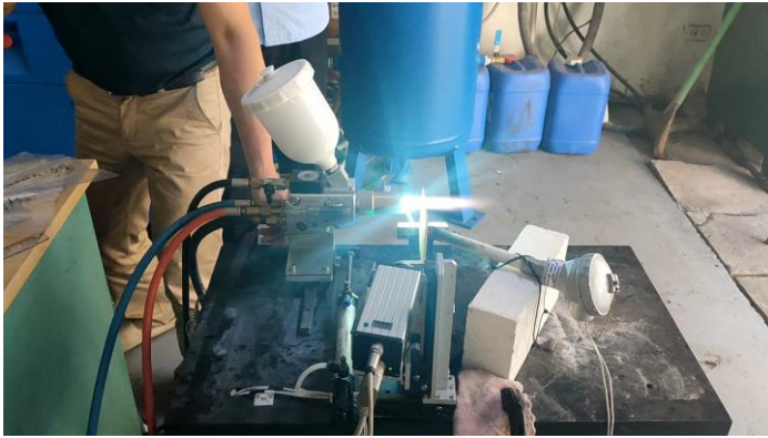
Hình 3. Thử nghiệm mài mòn nhiệt sử dụng dòng khí nóng ổn định được sinh ra từ phản ứng cháy oxy-axetylen.
