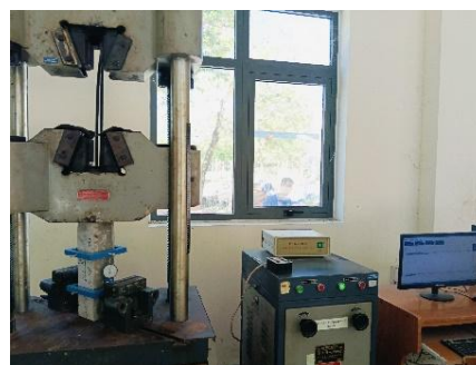
Hình 7. Thí nghiệm môđun đàn hồi.
