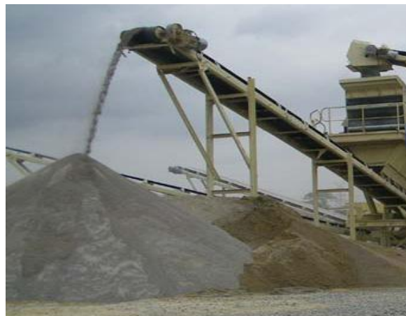
b). Vật liệu san lấp từ đá dăm 0 \div 4,0 cm và tro bay
