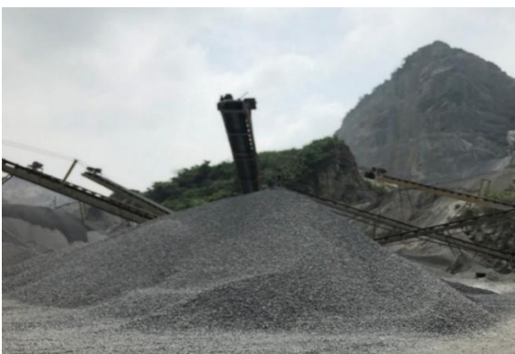
Hình 3. Khai thác và chế tạo đá dăm 0 ÷ 4,0 cm tại xưởng sản xuất ở Tây Ninh.
