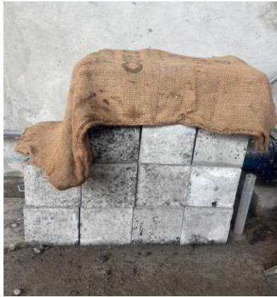
a). Bảo dưỡng mẫu bê tông sau khi tạo hình
