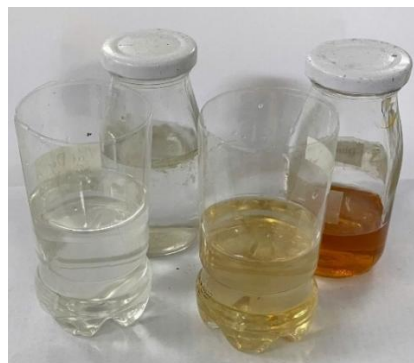
Hình 3. Phụ gia siêu dẻo vào nước sạch nhằm trộn hỗn hợp bê tông.
