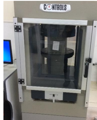
b). Nén mẫu bê tông thí nghiệm
