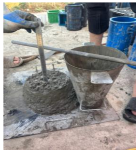
a). Xác định tính công tác của hỗn hợp bê tông
