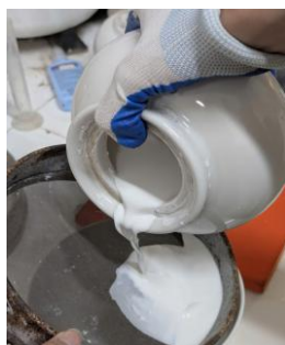
Bước 4: Sau 2h nghiền, men được lấy ra và sàng qua sàng 0,045μm
