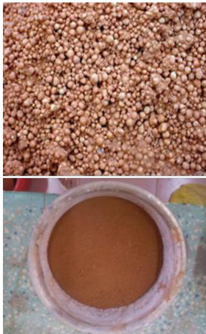
Hình 3. Quặng bô xít dạng rời và mẫu bùn đỏ đuôi quặng thí nghiệm.
