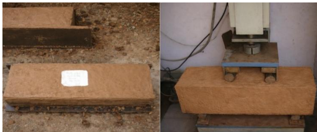
Hình 9. Thí nghiệm xác định cường độ kéo khi uốn.
