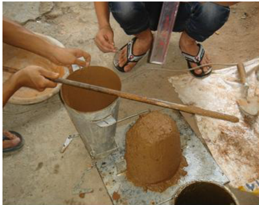
Hình 4. Thử độ sụt của hỗn hợp bê tông bằng côn Abram.
