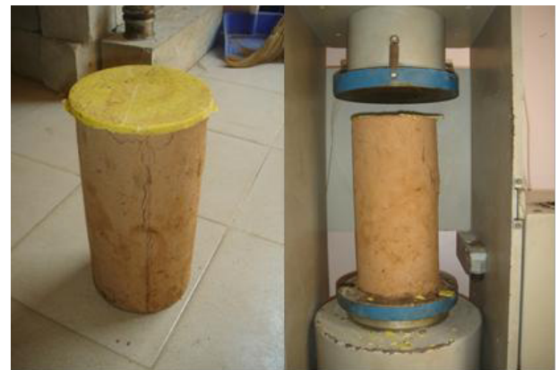
Hình 7. Chuẩn bị làm phẳng bề mặt mẫu và thử nén mẫu trụ chuẩn bê tông bùn đỏ.
