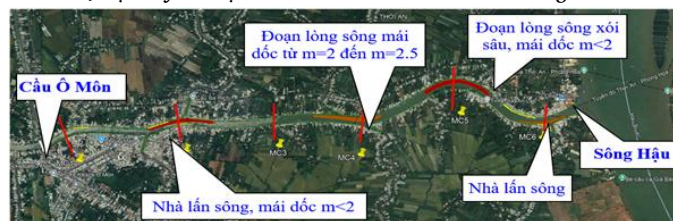
b) Bản đồ các vị trí mặt cắt xói lở và nhà lấn sông, năm 2020
