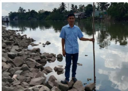
b) Đo mực nước thay đổi theo triều bằng thiết bị Sensor
