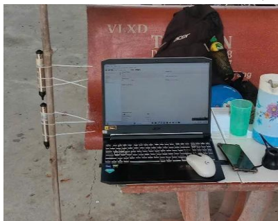
b) Đo mực nước thay đổi theo triều bằng thiết bị Sensor
