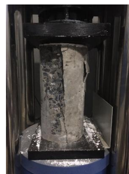
Hình 8. Thí nghiệm xác định cường độ chịu nén của bê tông.
