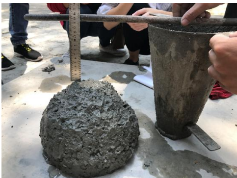
Hình 7. Thí nghiệm xác định độ sụt của hỗn hợp bê tông.
