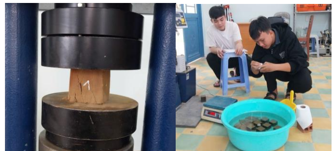
Hình 8. Một số hình ảnh thí nghiệm nén và độ hút nước của mẫu.
