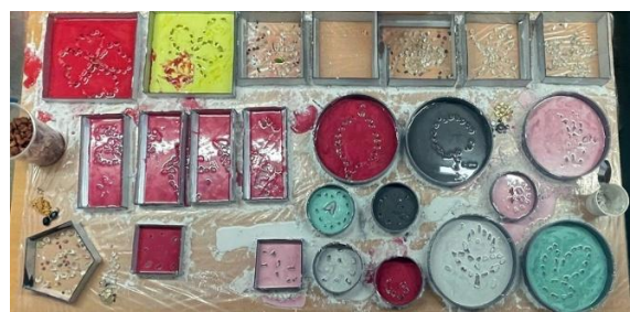
Hình 13. Chuẩn bị khuôn mẫu, đổ hỗn hợp bê tông xanh vào khuôn tạo hình sản phẩm.
