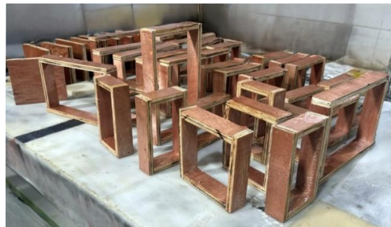
Hình 12. Khuôn gỗ để tạo hình sản phẩm.
