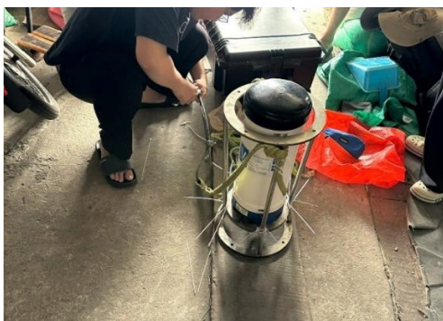
Hình 3. Lắp đặt ADCP Sentinel-V20 vào hệ khung.
