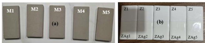
Hình 3. Ảnh chụp các mẫu các mẫu xương gạch được sử dụng để phun men (a); các mẫu gạch men nano ZnO (Z1, Z2, Z3, Z4, Z5); và các mẫu gạch men nano Ag@ZnO (ZAg1, ZAg2, ZAg3, ZAg4, ZAg5) sau khi nung (b).
