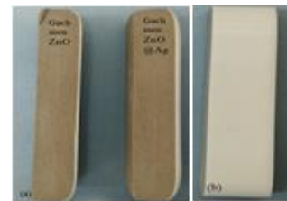
Hình 4. Hình ảnh cắt ngang các mẫu gạch men ZnO và ZnO@Ag (a) và Hình ảnh bề mặt gạch men cắt theo tiêu chuẩn để khảo sát cường độ bền uốn (b).
