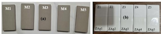
Hình 3. Ảnh chụp các mẫu các mẫu xương gạch được sử dụng để phun men (a); các mẫu gạch men nano ZnO (Z1, Z2, Z3, Z4, Z5); và các mẫu gạch men nano Ag@ZnO (ZA1, ZA2, ZA3, ZA4, ZA5) sau khi nung (b).
