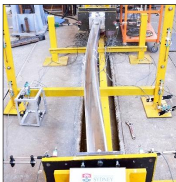
Hình 3. Mất ổn định uốn-xoắn của mẫu thí nghiệm.
