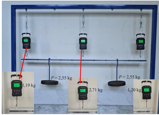
Hình 8. Mô hình thí nghiệm xác định phản lực tại ba điểm treo của vật nặng bằng cân treo điện tử, với tải trọng tập trung cách đầu A 0,2L và đầu B 0,2L ; có khối lượng P = 2,55 kg đặt lệch mỗi nhịp và phản lực đo được tại các điểm treo lần lượt là 1,19 kg; 2,71 kg và 1,20 kg.
