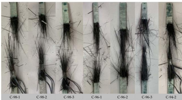
Hình 14. Phá hoại sợi các bon trong thí nghiệm xác định giới hạn từ biến [35].
