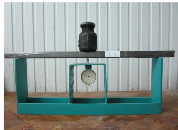
Hình 3. Sơ đồ gia tải tập trung và vị trí đặt đồng hồ đo độ võng tại giữa nhịp đầm.
