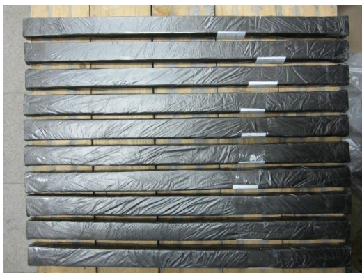
Hình 2. Các mẫu đầm được bọc kín để đảm bảo độ ẩm không đổi trong suốt quá trình thử nghiệm.
