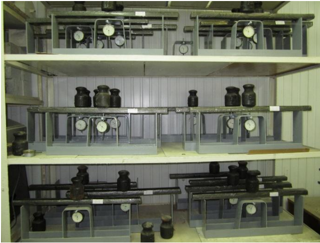
Hình 4. Hệ thống thiết bị thử nghiệm từ biến đồng thời cho nhiều tổ mẫu tại phòng thí nghiệm.
