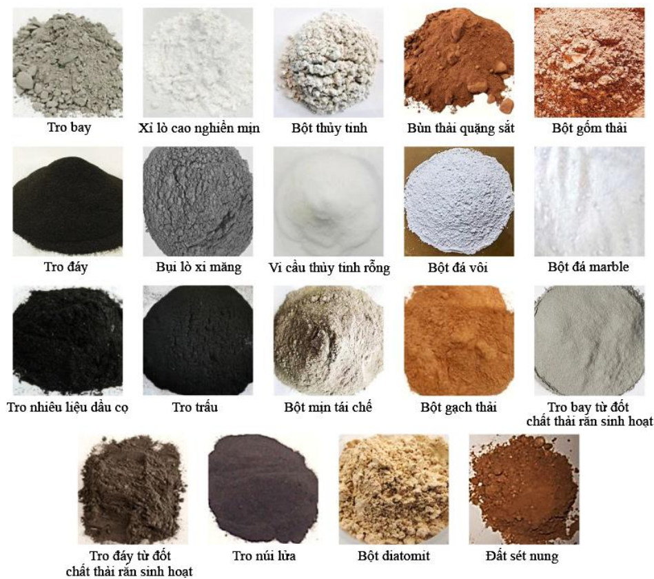
Hình 2. Các loại phụ gia khoáng thường được sử dụng trong ECC [27].
