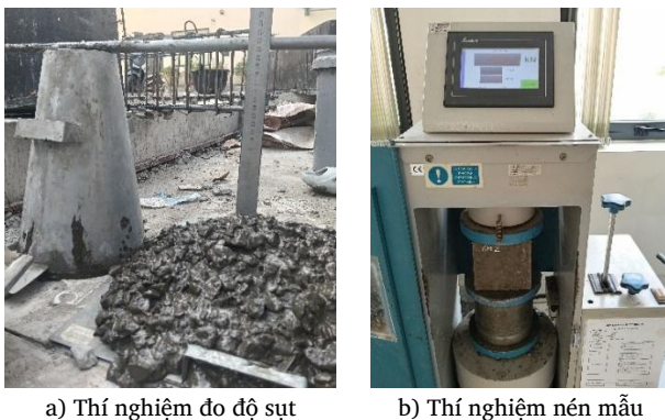
Hình 5. Thí nghiệm độ sụt và thí nghiệm nén mẫu bê tông geopolimer.
