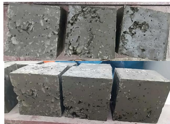
Hình 7. Mẫu bê tông geopolimer sử dụng 100 % cát nghiền xuất hiện rỗ bề mặt.
