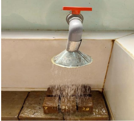
Hình 7. Thử nghiệm khả năng chịu nước dưới dạng mưa rào.
