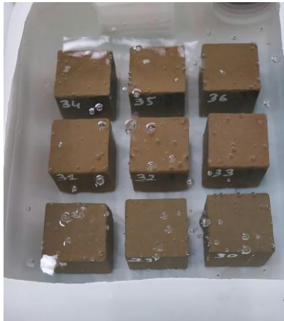
Hình 8. Ngâm mẫu thí nghiệm nén bão hòa.
