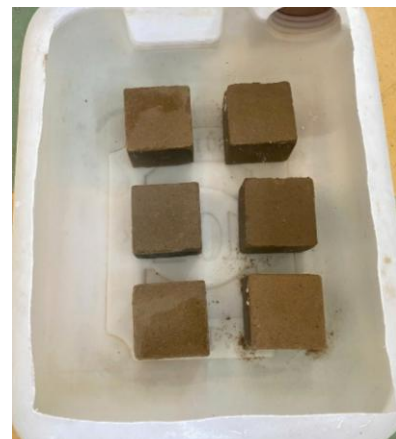
Hình 6. Thử nghiệm sự phân rã của gạch khi ngâm trong nước.
