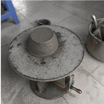
Hình 13. Bàn dần thử độ xòe của hỗn hợp vữa xi măng PC40.
