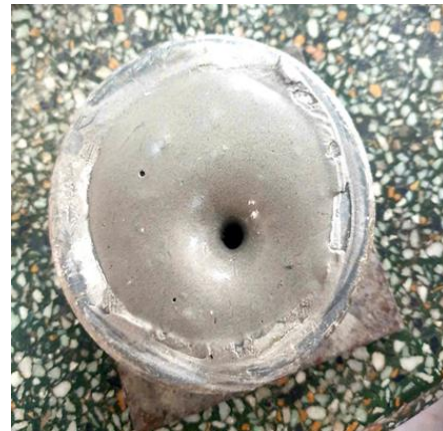
Hình 9. Dạng vết lún kim to CKD geopolimer đạt độ dẻo tiêu chuẩn.
