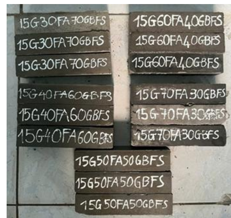
Hình 16. Sau 2 ngày tháo khuôn và bảo dưỡng mẫu vữa geopolymer tự nhiên.
