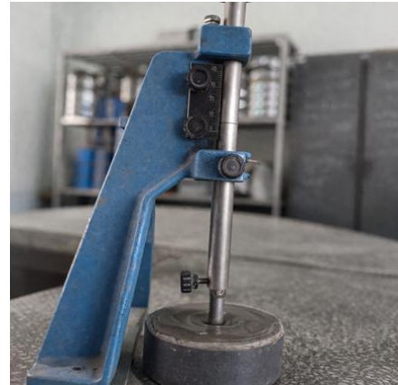
Hình 8. Độ lún kim to của mẫu đối chứng hồ XM PC40 đạt độ dẻo tiêu chuẩn.
