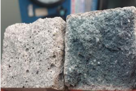
Hình 21. Cấu trúc vi mô của vữa XMPC40 và vữa geopolimer sau khi phá hoại.
