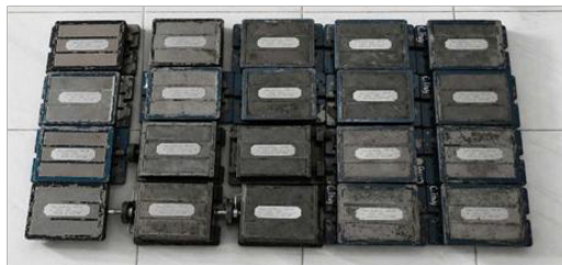
Hình 7. Máy đầm mẫu vữa và khuôn đúc mẫu vữa chuẩn.
