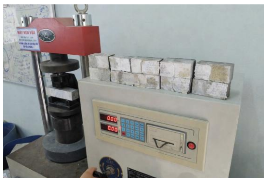
Hình 18. Thí nghiệm xác định cường độ kéo khi uốn.
