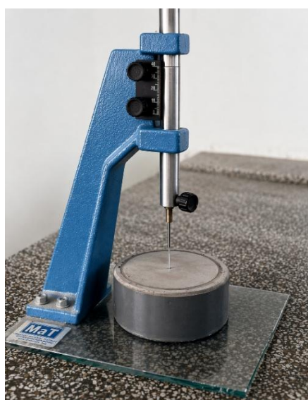
Hình 11. Độ lún kim nhỏ thử thời gian đông kết của mẫu hồ Geopolymer.
