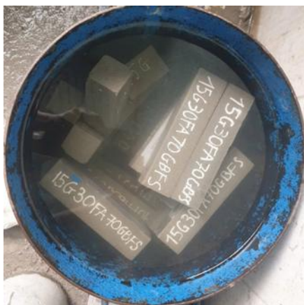
Hình 17. Bảo dưỡng mẫu vữa geopolimer trong nước sau 2 ngày để nhiệt độ phòng.
