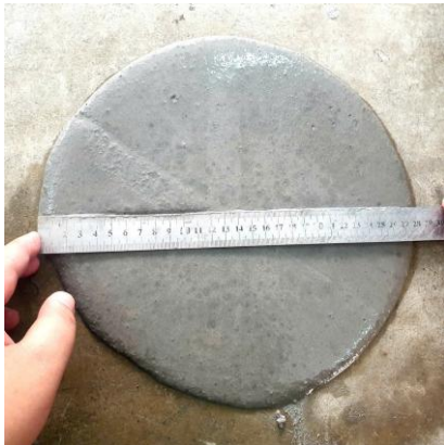
Hình 14. Đo độ xòe của hỗn hợp vữa geopolymer.
