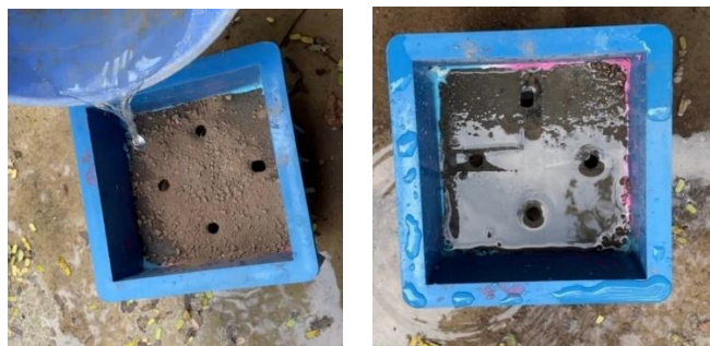
Hình 10. Thí nghiệm về khả năng chống tắc, tự làm sạch bề mặt.
