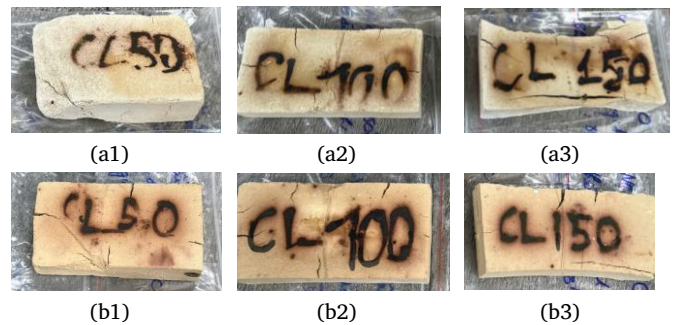
Hình 7. Mẫu cốt liệu chịu lửa tạo hình ép bán khô sau nung (a1) CL50-1250; (a2) CL100-1250; (a3) CL150-1250; (b1) CL50-1350; (b2) CL100-1350; (b3) CL150-1350.
