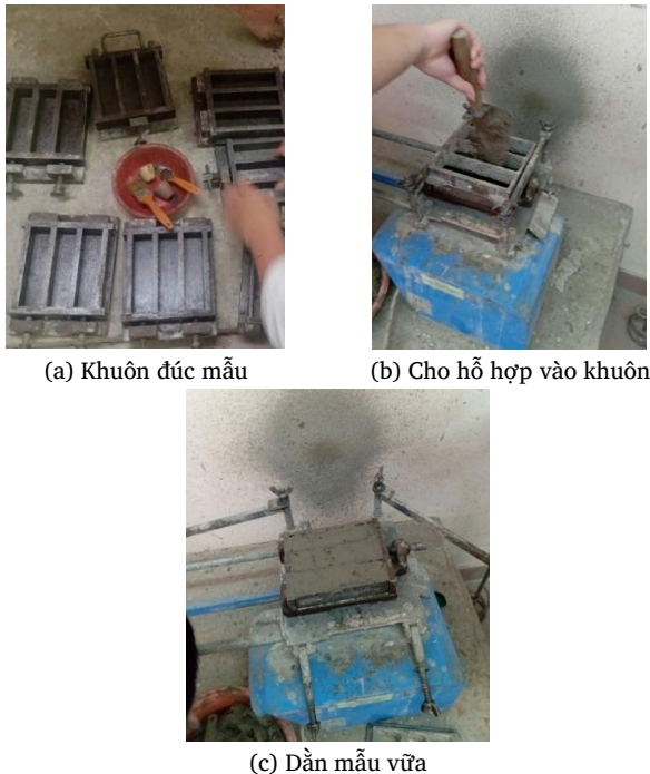
Hình 2. Tạo mẫu vữa kích thước 40x40x160 mm.
