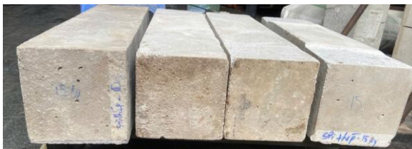
Hình 1. Các mẫu dầm bê tông với kích thước 150×150×600 mm được chế tạo tại công trường.
