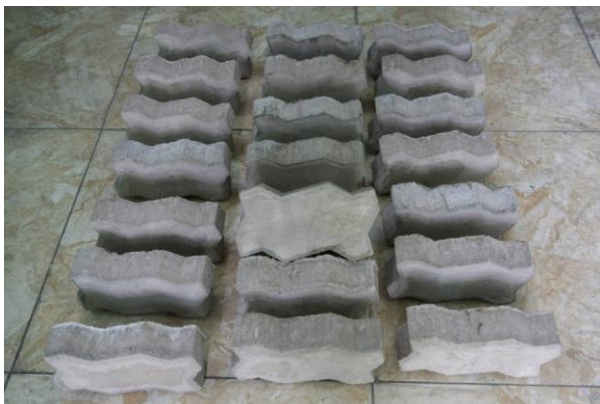
Hình 3. Sản phẩm mẫu gạch tự chèn sử dụng đá thải mỏ và tro xi nhiệt điện.
