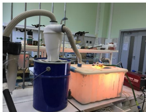
Hình 1. Xử lý cát thạch anh bằng plasma nhiệt độ thấp.
