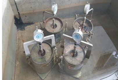
Hình 2. Chuẩn bị mẫu và thí nghiệm trong phòng: (a) chuẩn bị mẫu đầm nén; (b) xác định độ trương nở; (c) thí nghiệm xác định CBR.
