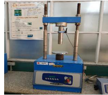
Hình 2. Chuẩn bị mẫu và thí nghiệm trong phòng: (a) chuẩn bị mẫu đầm nén; (b) xác định độ trương nở; (c) thí nghiệm xác định CBR.
