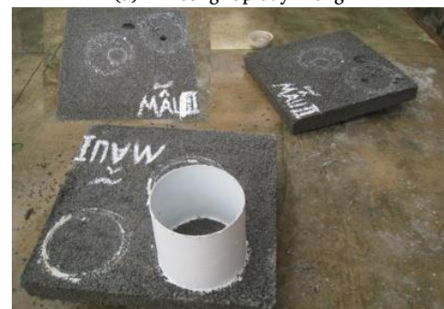
(b) Đo thấm mẫu thử của tấm BTXMR
