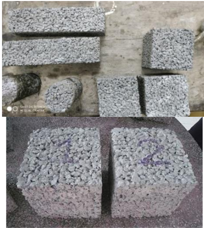
Hình 6. Các mẫu bê tông xi măng rỗng sau khi tháo ván khuôn.
