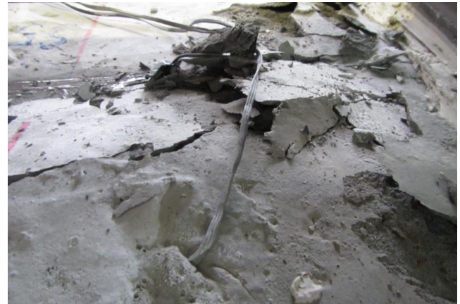
Hình 13. Phá hoại của dầm CB1 & CB2 (nhìn từ mặt trên).
