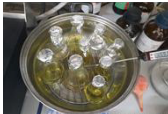
d) Chuẩn bị hóa chất phân tích formaldehyde bằng quang phổ UV-Vis
