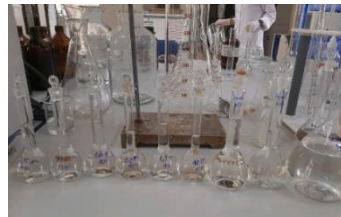
d) Chuẩn bị hóa chất phân tích formaldehyde bằng quang phổ UV-Vis
