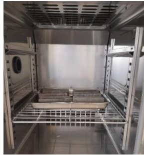
a) Chuẩn bị mẫu thử nghiệm và ổn định mẫu thử trong 7 ngày
