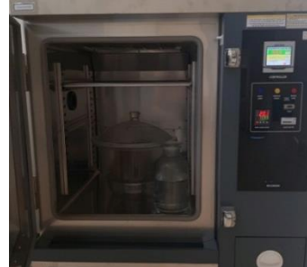
c) Mẫu được đặt trong tủ ổn nhiệt để duy trì nhiệt độ thử nghiệm
