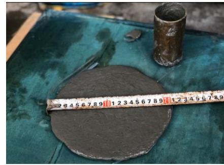
Hình 8. Thí nghiệm độ chảy xòe.
