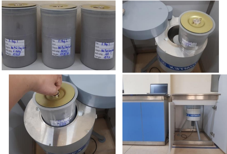
Hình 1. Thử nghiệm đo phóng xạ trong mẫu xi thép.
