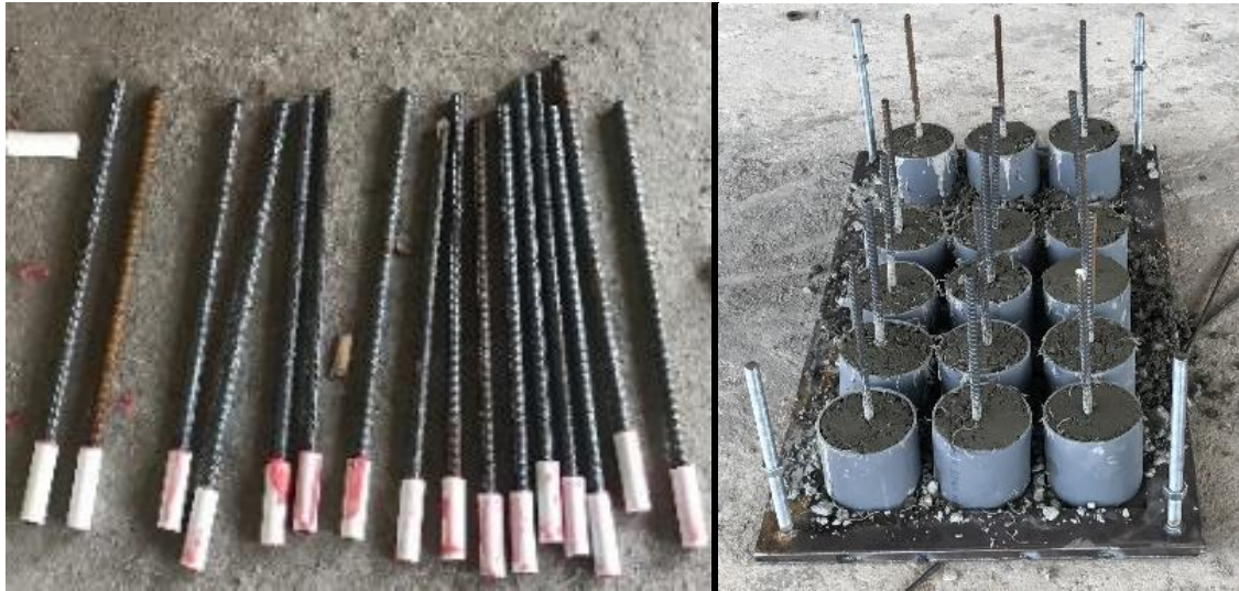
Hình 1. Chuẩn bị mẫu thử cường độ nén và bám dính của cốt thép với bê tông.
