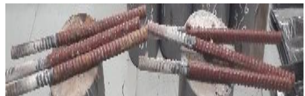
Hình 6. Ngoại quan thanh cốt thép của mẫu thử độ bám dính sau khi thử.
